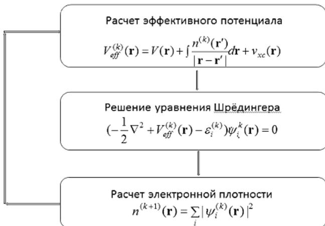
**Рис. 2.8.** Схема итерационного процесса для получения самосогласованного решения уравнений Кона–Шэма
