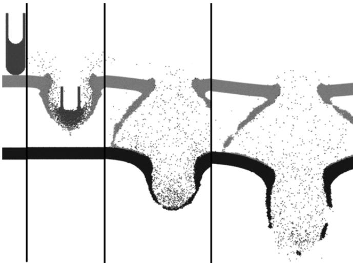
**Рис. 4.16.** Пробитие ударником двух разнесенных преград толщиной 10 мм [6]
