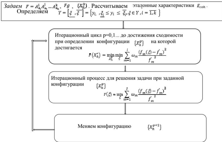
**Рис. 3.1а.** Общая блок-схема алгоритма параметрической идентификации
